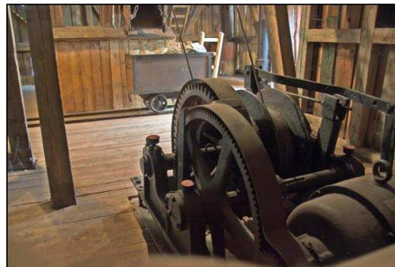
Abbildung 46: Elektrische Fördermaschine vom Typ OK 1 aus dem Jahr 1949 in der Kaue der Grube Sauschwart [Kugler, Jens 2007]
