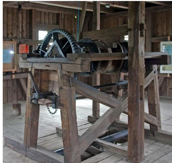
*Abbildung 34: Haspel im Obergeschoss des Treibehauses vom IV. Lichtloch [F.: J. Kugler, 2007]*
