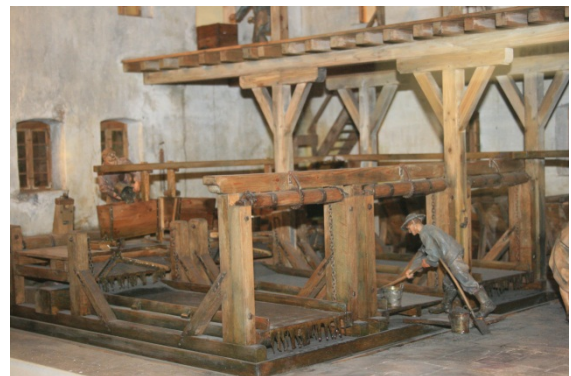
Abbildung 6: Modell einer Stoßherdwäsche im Deutschen Museum in München [F.: Kugler, 2006]
